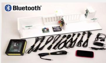
L'objet connecté doit comporter des **capteurs** et des **actionneurs** reliés à une **interface**. Pour le piloter, le **smartphone** ou l'**ordinateur** doit comporter une application.
